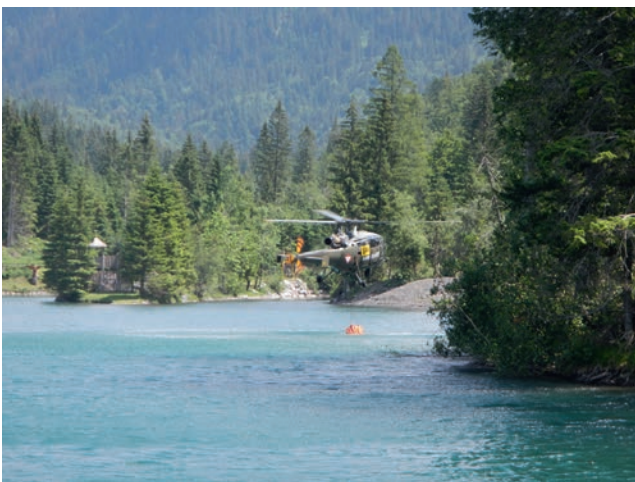
Bild 3: Da wir in diesem Sommer mit relativ wenig Niederschlag rechneten, ersuchten wir um Auffüllen der beiden Wasserbehälter im Höhenlager. Diese werden mit Hilfe eines „Bambi Bucket“ (Löschwasser-Außenlastbehälter für Hubschrauber) befüllt. Den Behälter füllt unser Pilot selbstständig, indem er ihn im See volllaufen lässt.
