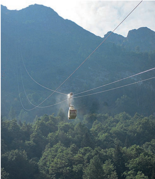
Bild 1: Der Sprühnebel des Kriechöls ist hier gut zu sehen. Es wird ein umweltfreundliches Produkt verwendet.
